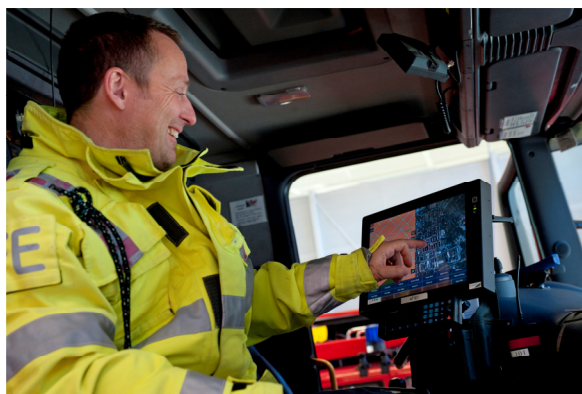
I flera av förbundets räddningsfordon finns fordonsdatorer installerade, vilket gör det möjligt för räddningsledaren att bl.a. på insatskortet se hela kvarteret och zooma in på olycksobjektet.
